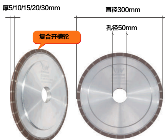
产品品牌: 博威工具 产品名称: 金刚树脂复合轮 产品规格: 直径300mmx孔径50mmx厚5/10/15/20/30mm 使用范围: 岩板、陶瓷、玻化砖、微晶石、大理石、花岗岩
