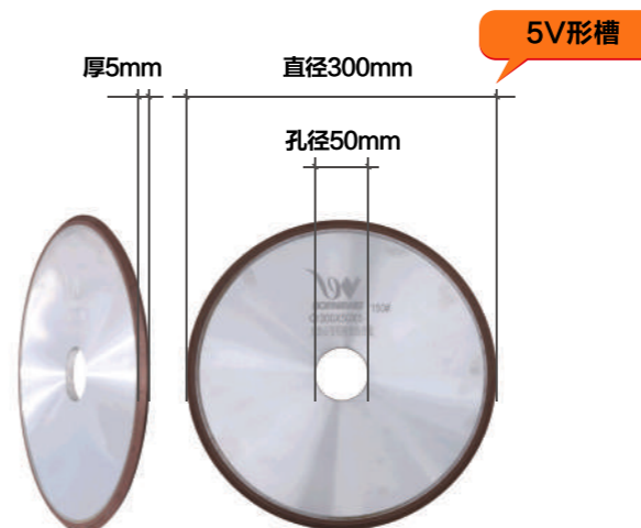
产品品牌: 博威工具 产品名称: 树脂开槽轮 产品规格: 直径300mmx孔径50mmx厚5mm 使用范围: 岩板、陶瓷、玻化砖、微晶石、大理石、花岗岩
