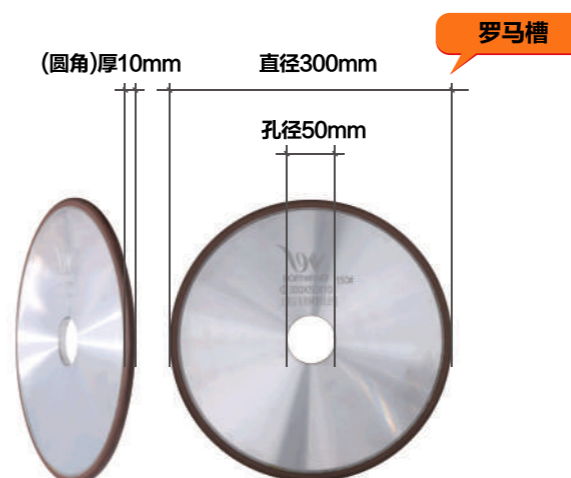
产品品牌: 博威工具 产品名称: 树脂开槽轮 产品规格: 直径300mmx孔径50mmx圆角10mm 使用范围: 岩板、陶瓷、玻化砖、微晶石、大理石、花岗岩
