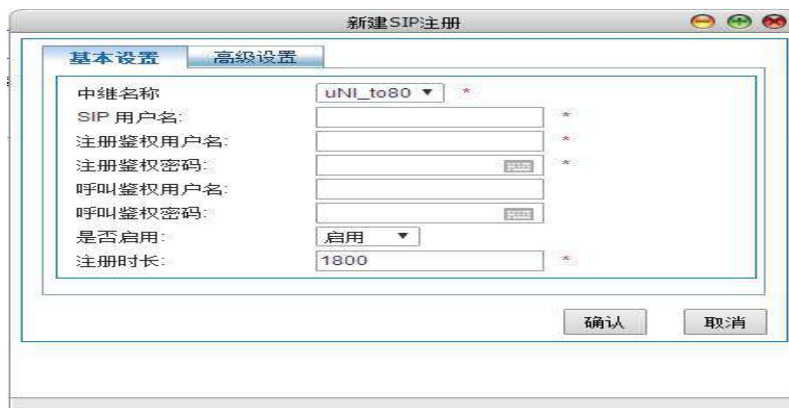
图 6-30 SIP 注册-新建隐式注册集-基本设置
