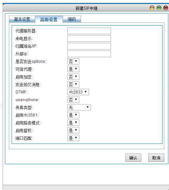
图 6-27b 新建 SIP-高级设置(适用接口类型为 NNI)
