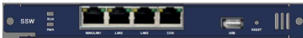
图 1-2 IP PBX8000 SSW 系统交换板外观图
