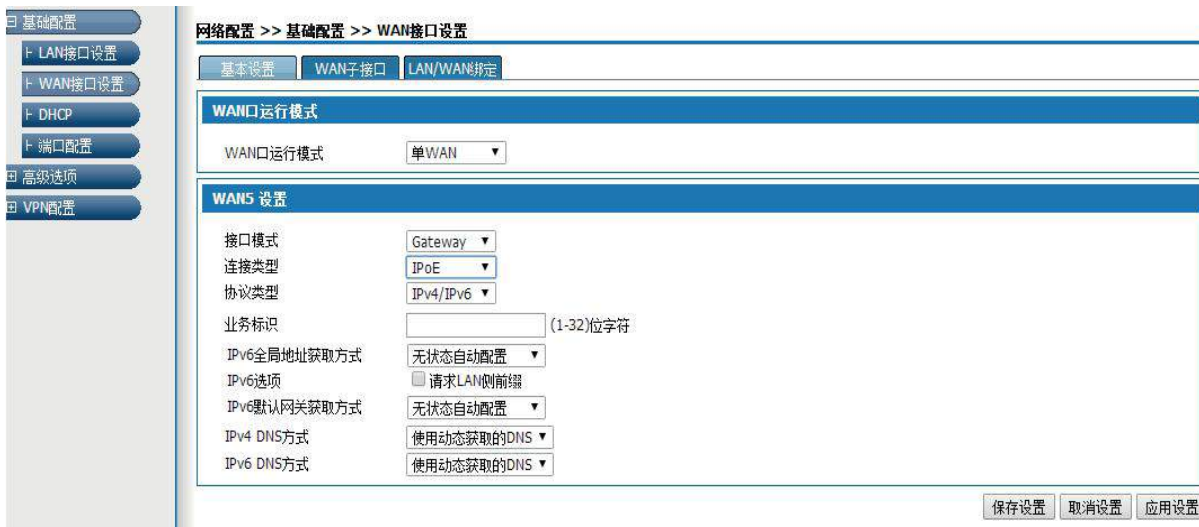
图 5-6 IPoE 方式获取 IP 地址
