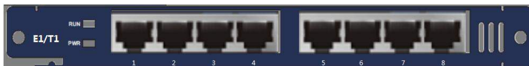
图 1-5 IP PBX8000 8E1/T1 数字中继板外观图
