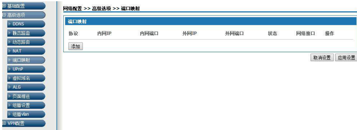
图 5-17 端口映射设置
