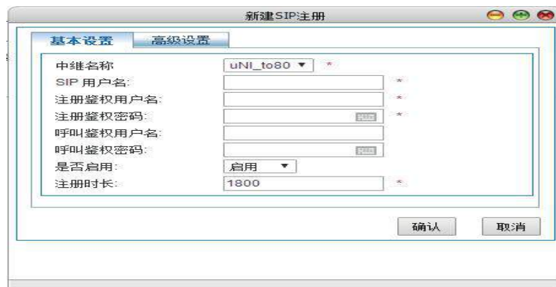
图 6-30 SIP 注册-新建隐式注册集-基本设置
