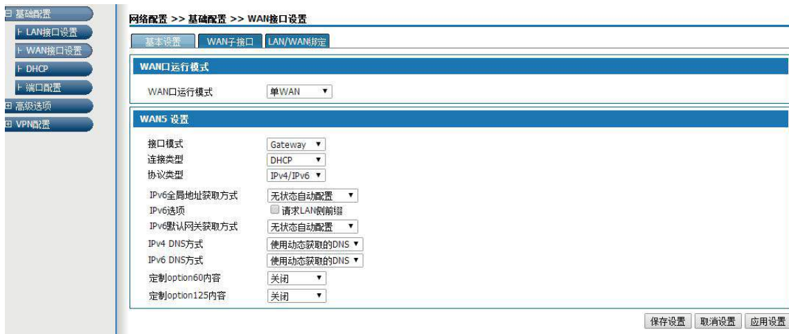
图 5-5DHCP 方式获取 IP 地址
