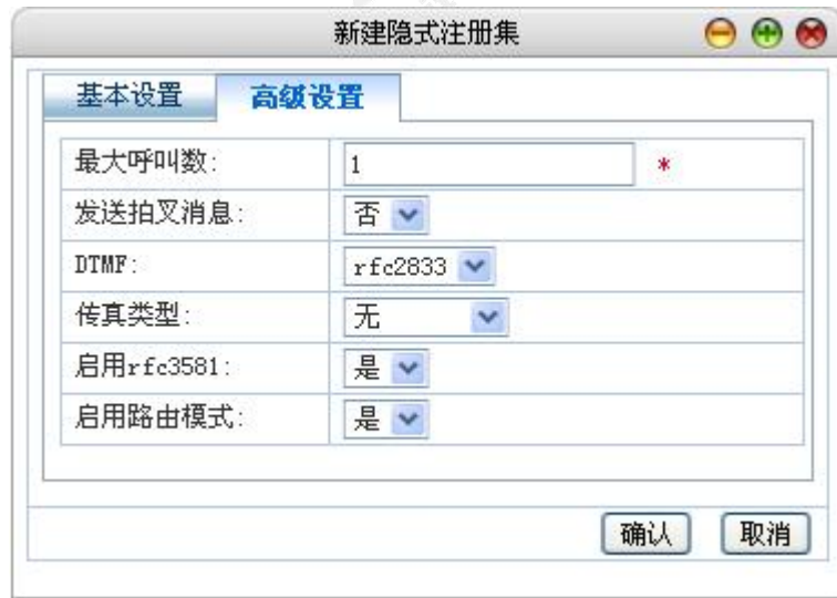
图 5-15 SIP 注册-新建隐式注册集-高级设置
